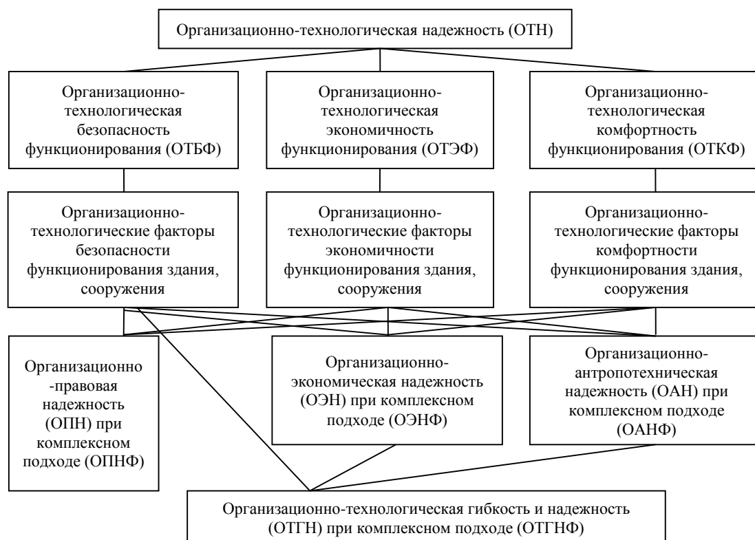
Рисунок 2. Модифицированная структурная схема критерия ОТН, адаптированная к условиям комплексного функционирования здания, сооружения
