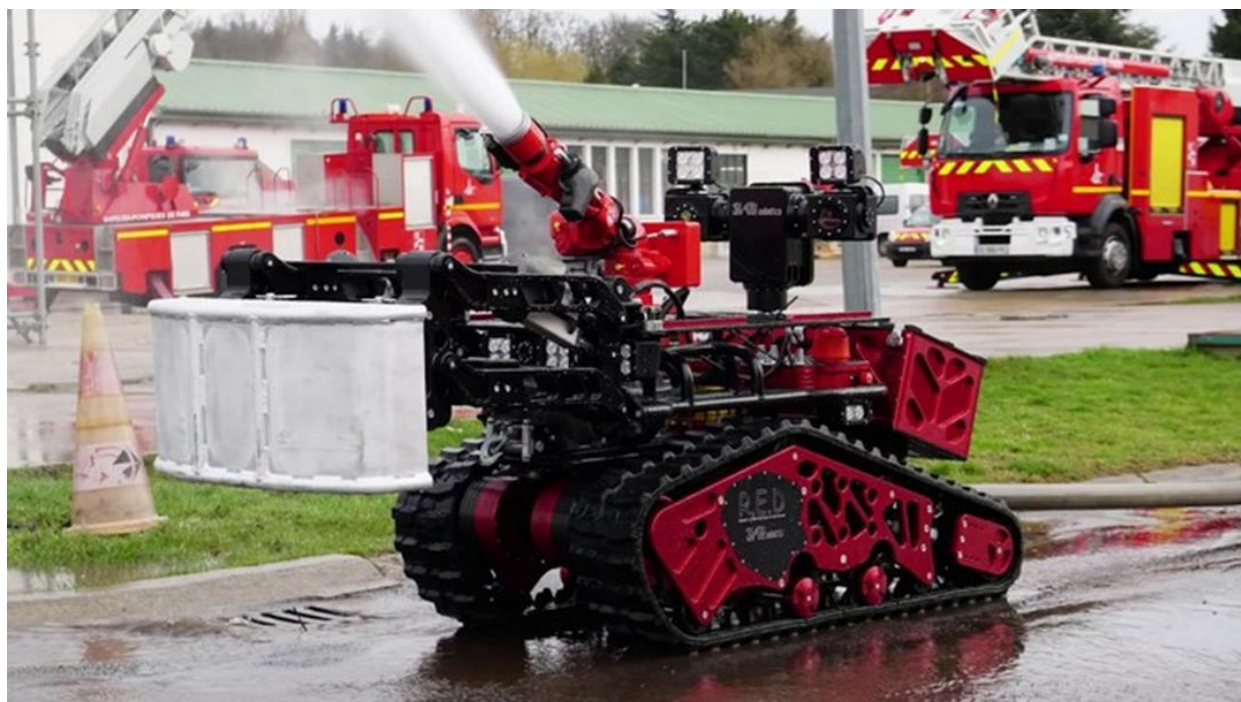
Рисунок 7. Робот-пожарный с системой навигации на основе LiDAR (источник: https://vdo.pf/img/blog/post/42fc6a7d-35ab-4070-b018-b73df9f57682.jpg )
