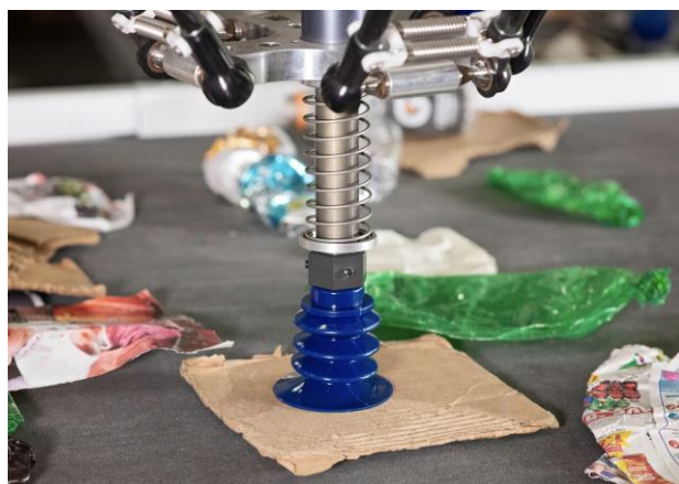
Рисунок 1. Пневматический манипулятор, применяемый для сортировки на конвейерных лентах (фото с сайта, URL: https://spectrum.ieee.org/ai-guided-robots-are-ready-to-sort-your-recyclables )
