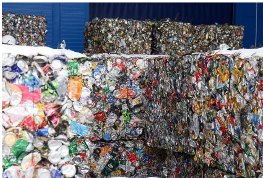
Рисунок 1. Пример пакетированных бытовых отходов, подготовленных для механизированной погрузки и транспортировки на вторичную переработку и дальнейшее использование
