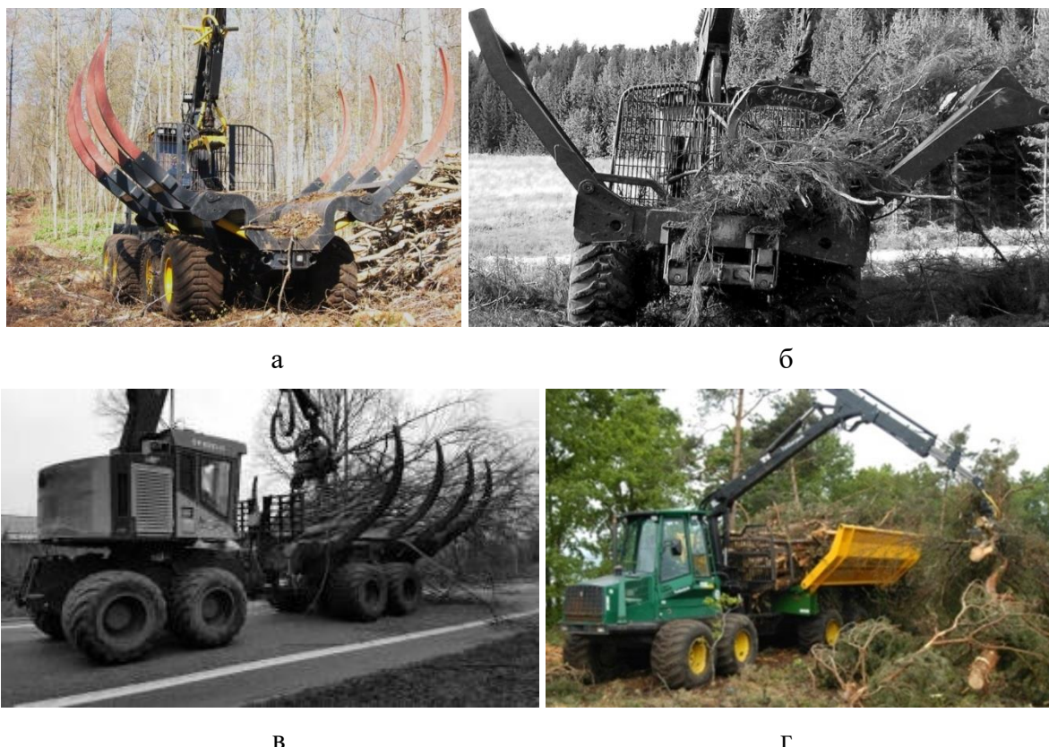
Рисунок 4. Машины с прессующим кузовом: а – Ponsse BTS (фото Ponsse); б – ABAB REDET (фото Allan Bruks AB); в – TimberPro 810B (фото TimberPro); г – Dutch Dragon (фото Dutch Dragon)
