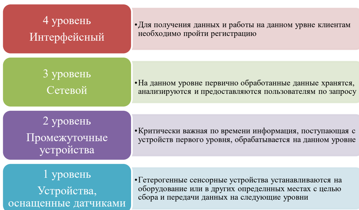
Рисунок 2. Многоуровневая архитектура управления безопасностью технологических процессов с использованием IoT (составлено авторами)
