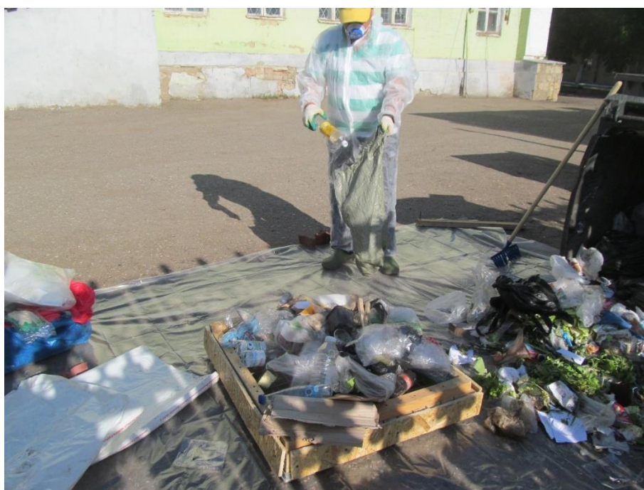
Рисунок 1. Исследование состава ТКО с применением сита (фото автора)
