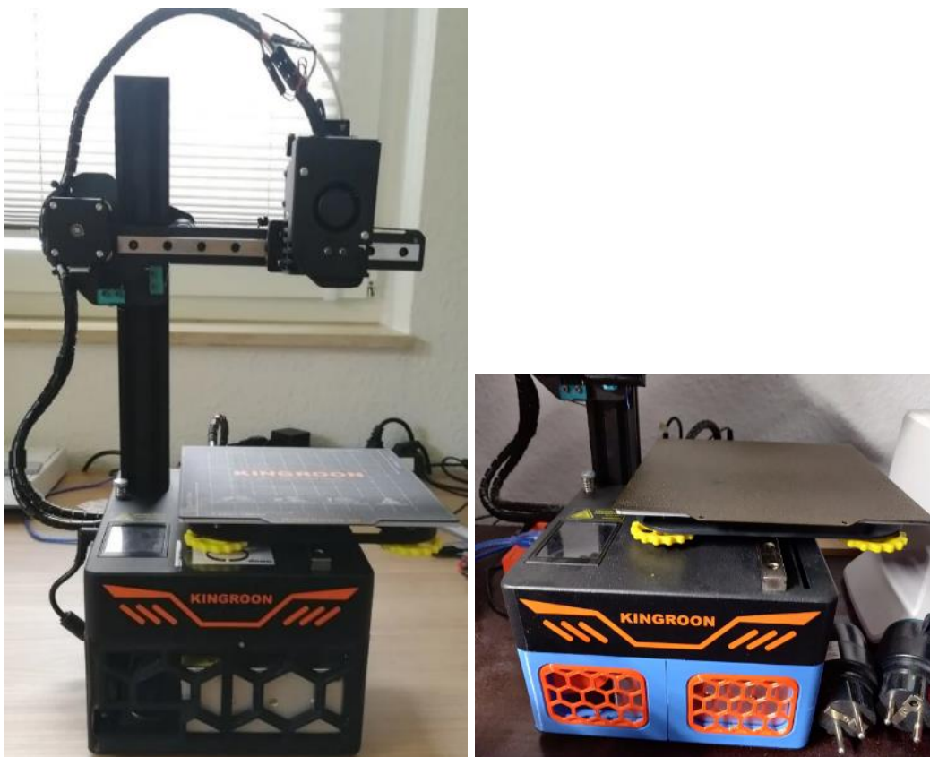
Рисунок 6. Варианты для размещения БП в одном корпусе принтера (составлено/разработано автором)
