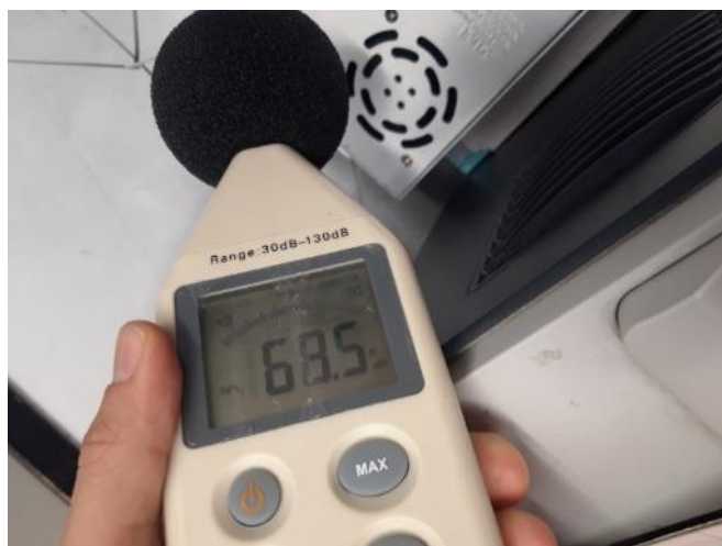
Рисунок 8. Исследование шума с прибором модели GM1357 (составлено автором)
