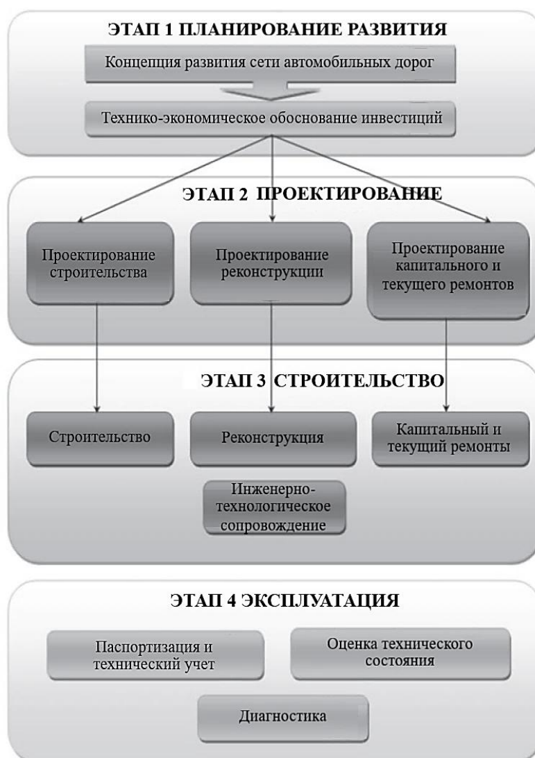
Рисунок 1. Использование ГИС технологий в течение жизненного цикла автомобильной дороги (разработано автором)
