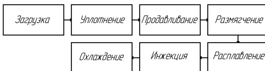
Рисунок 3. Схема процесса литья под давлением (составлено/разработано автором)
