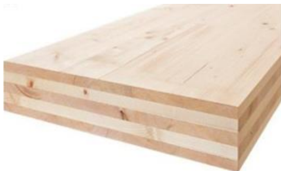
Рисунок 1. Сборные поперечно-ламинированные панели. Панели CLT могут быть размером до 16х3.2 м. Тепловые свойства панелей CLT зависят от используемой древесины; плотность обычно составляет около 500 кг/м 3 и имеет значение теплопроводности 0.13 Вт/Мк [11]
